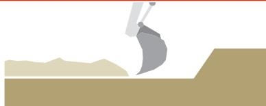
Das tragfähige Planum muss mindestens 30 cm über dem höchsten Grundwasserspiegel liegen. Das Planum soll in der Mitte leicht überhöht ausgeführt werden und mit einer Rüttelplatte abgerüttelt werden. Bei bindigen oder geschichteten Böden ist eine Drainage nach der Norm DIN 4095 vorzusehen (siehe Detail S001 und S002)
