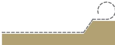
Geotextil (mind. 150 g/m<sup>2</sup>) als Trennlage mit 10 cm Stoßüberdeckung auf dem Planum verlegen. Im Randbereich ist ein ausreichender Überstand vorzusehen, damit die fertig eingebrachte Schüttung später im Randbereich abgedeckt werden kann.
